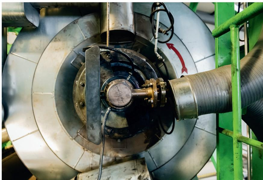
3 Blick in einen der beiden Vakuumtrockner, die beim Verfahren Vakuum-Destillation die feuchten Bestandteile des Schlammes (Öl und Wasser) von den festen Bestandteilen (Metall) trennen (© Cronimet Envirotec)
