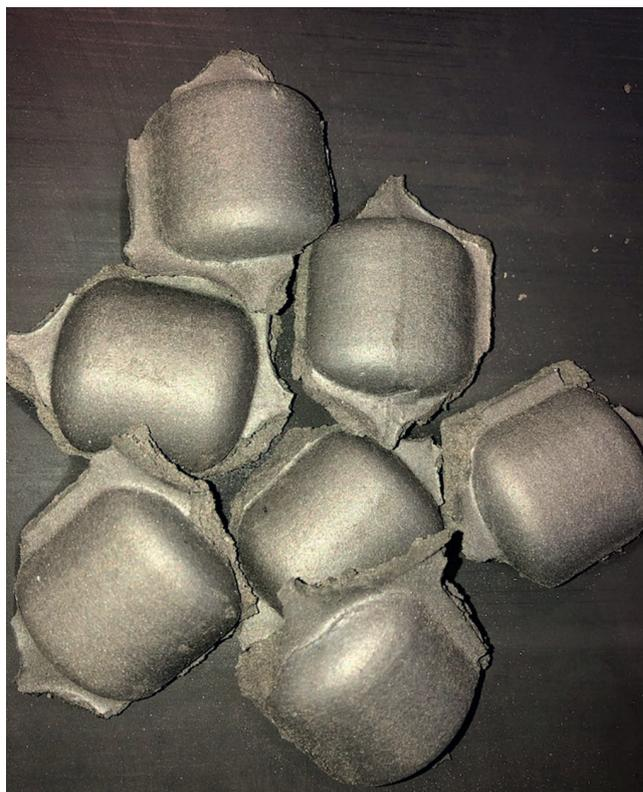
1 Diese nach der Vakuüm-Destillation mit einem organischen Bindemittel erzeugten Reststoff-Briketts sind deutlich härter als übliche und quasi ölfrei
